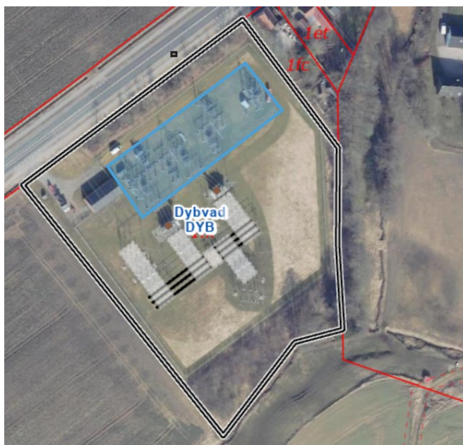
Figur 1-2. Eksisterende højspændingsstation Dybvad. Det blå er Nord Energi Net A/S anlæg, mens det resterende er Energinets.
