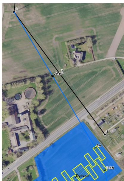
Figur 1-4. Indsløjfning af luftledning fra nord
